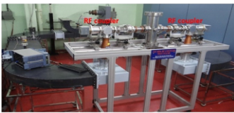
उच्च-शक्ति 325 MHz अनुनाद वलय परीक्षण स्टैंड जिसमें से दो एकीकृत प्रोटोटाइप युग्मक परीक्षण के दौर से गुजर रहे हैं
